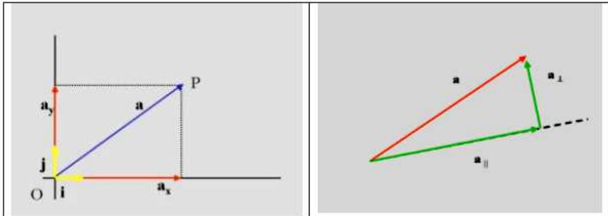
**Fig. 5** - Scomposizione di un vettore nelle sue due componenti lungo direzioni tra loro perpendicolari (a sinistra). Scomposizione di un vettore lungo una direzione qualunque (a destra).
