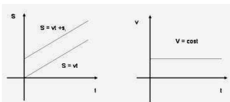
**Fig. 4** – Grafici orari spazio-tempo (a sinistra) e velocità-tempo (a destra) di un M.R.U.
