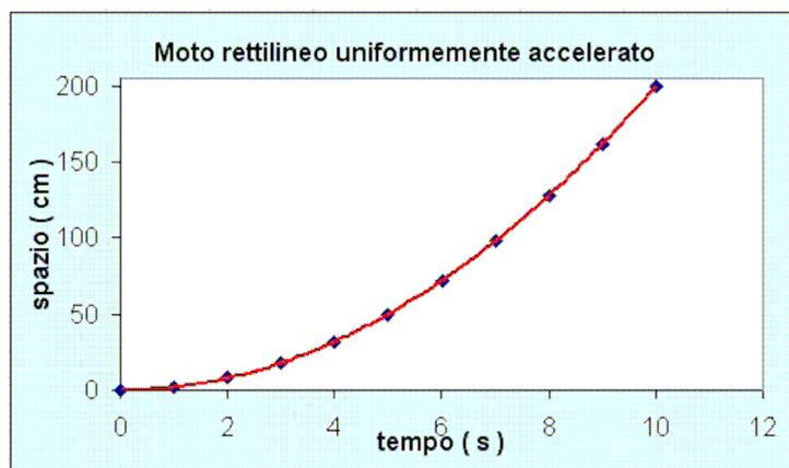
**Fig. 10** - *Grafico orario spazio-tempo del moto rettilineo uniformemente accelerato*
