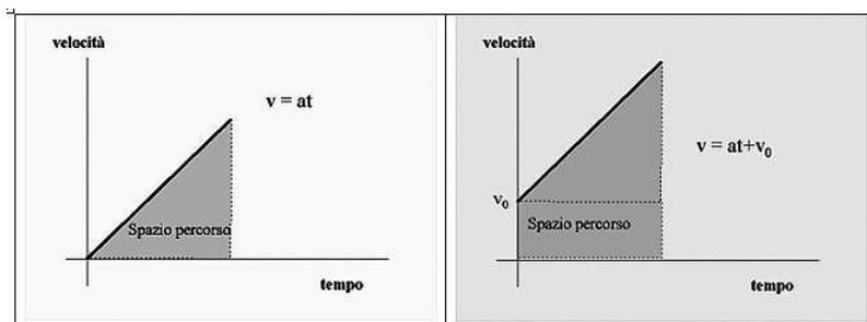
Fig.11.4 - Grafico orario velocità-tempo di un moto rettilineo uniformemente accelerato con velocità iniziale nulla (a sinistra) e velocità iniziale  $v_i$  (a destra). L'area evidenziata in grigio fornisce il valore dello spazio percorso.
