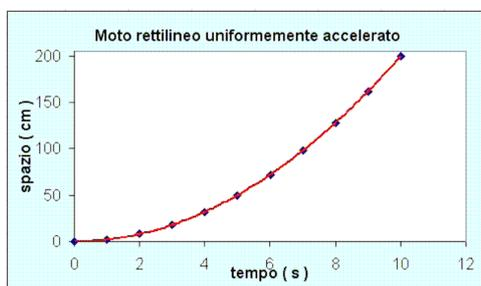
Fig.11.3 - Grafico orario spazio-tempo del moto rettilineo uniformemente accelerato.
