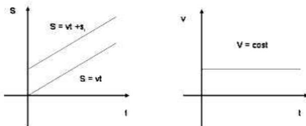
**Fig.11.1** - Grafici orari spazio-tempo (a sinistra) e velocità-tempo (a destra) in un M.R.U.
