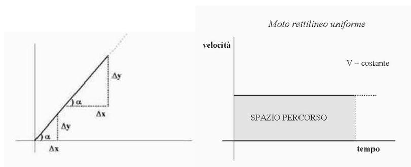
**Fig.11.2** - In un grafico spazio-tempo (a sinistra) il coefficiente angolare della retta fornisce il valore della velocità. In un grafico velocità-tempo (a destra) l'area compresa tra la curva e l'asse delle ascisse dà il valore dello spazio percorso.
