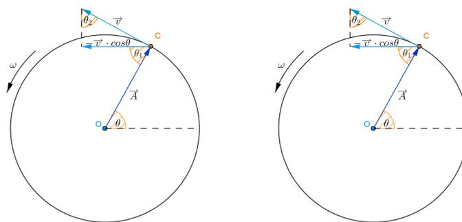
Figura 12.10: Deduzione della velocità e dell'accelerazione in un moto armonico.
