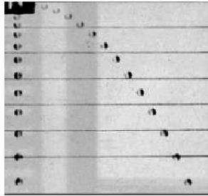
Figura 12.1: *Fotografia stroboscopia di due oggetti che cadono dalla stessa quota: il primo ha velocità iniziale nulla, il secondo velocità iniziale con componente orizzontale diversa da zero. Poiché ad ogni istante si trovano alla stessa altezza, la componente orizzontale e quella verticale del moto del secondo oggetto sono tra loro indipendenti.*
