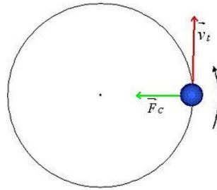
Figura 12.8: L'accelerazione centripeta è sempre diretta verso il centro della curva ed ha direzione perpendicolare al vettore velocità.
