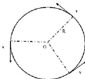
Figura 12.5: *Il moto circolare uniforme è un moto periodico in cui il modulo della velocità  $v$  rimane costante mentre la direzione del vettore velocità, essendo sempre tangente alla traiettoria, cambia ad ogni istante.*
