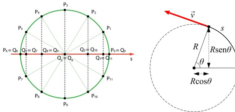
Figura 12.9: Mentre il punto  $P$  si muove sulla circonferenza a velocità angolare costante, la sua proiezione  $Q$  si sposta a velocità variabile lungo il diametro (a sinistra). La proiezione del moto di  $P$  sull'asse delle ascisse vale  $x = R \cos\theta$  (a destra).
