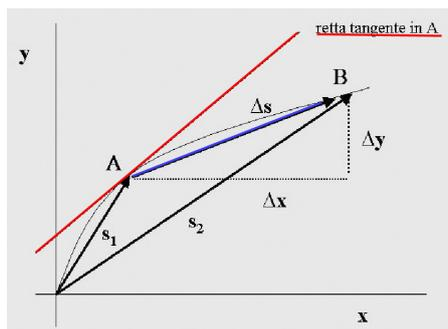
Figura 12.4: La direzione del vettore velocità coincide per definizione con quella del vettore spostamento  $\Delta\mathbf{S}$ . Quando, per istanti di tempo infinitesimi, i punti A e B tendono a coincidere, tale direzione è sempre tangente alla traiettoria nel punto considerato A.
