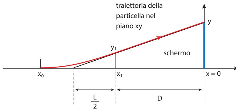
A questo risultato si può pervenire anche in modo diretto determinando l'equazione della retta tangente alla parabola nel punto di uscita dalla regione del campo. La pendenza della tangente si ottiene calcolando la derivata della parabola nel suo punto di ascissa  $x_1$ :
